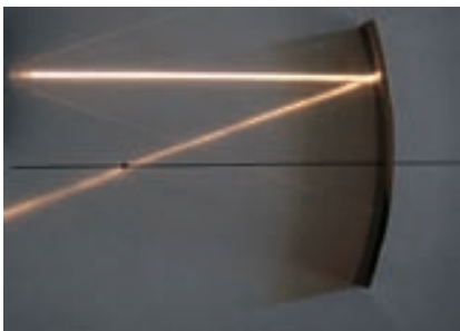
Un rayo que llega al espejo en forma paralela al eje óptico, se refleja en dirección al punto focal.
