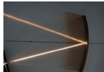
Un rayo dirigido al vértice del espejo se reflejará con el mismo ángulo respecto del eje óptico.
